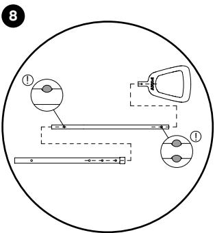
Spojte trubku posuvné tyče a držadlo.
