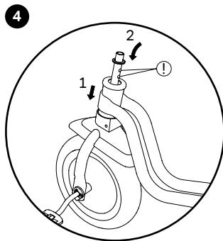
Sloupek vidlice zastrčte do duté tyče říditek až na doraz. Opět nasadte podložku. Výstupky na sloupu vidlice nasměrujte dozadu(!).
