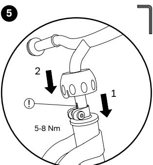
Lenker bis zum Anschlag auf den Gabelschaft aufstecken und Schraube festdrehen. Kugelhaube anschließend fest nach unten drücken bis sie einrastet. Schlitz im Lenkerschaft nach hinten ausrichten (!).
