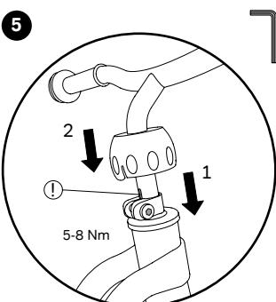
Sæt styret til anslag på gaffelskaftet og spænd skruen. Tryk derefter kuglekappen nedad til den går i indgreb. Positionér slidsen i frempinden bagudvendt (!).
