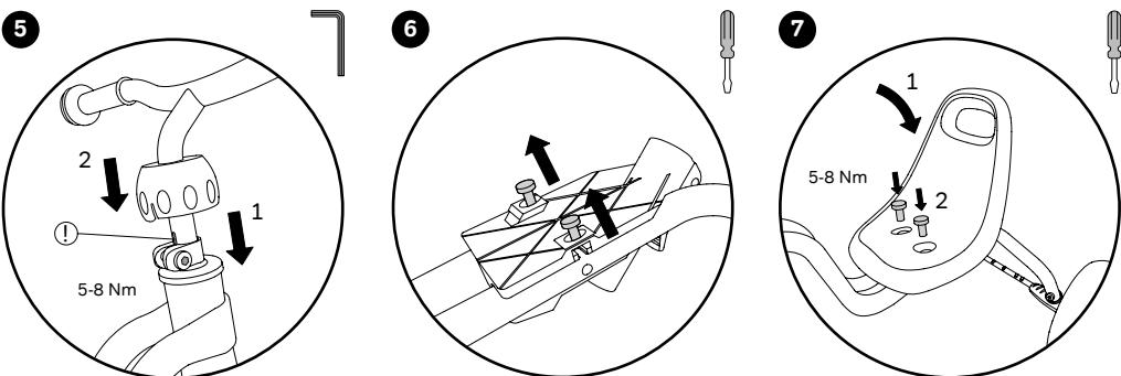
Stuur tot aan de aanslag op de vorkbus steken en schroef vastdraaien. Balafdekking vervolgens stevig omlaag drukken totdat deze vastklikt. Sleuf in stuurbus naar achteren uitlijnen (!).
