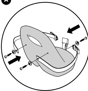
Fastgør seleenden med huller ved hjælp af de vedlagte skruer i de dertil beregnede huller på tricyklen's sæde. OBS! Spænd kun skruerne med hånden, da en for fast tilspænding beskadiger plastdelene.
