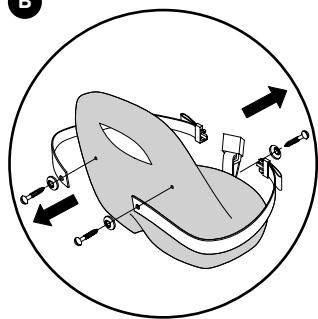
A Encastre los extremos perforados del cinturón con los tornillos adjuntos en el granulado del asiento del triciclo. ¡Atención! Apriete los tornillos a mano, pues si los aprieta demasiado podría dañar las piezas de plástico.
