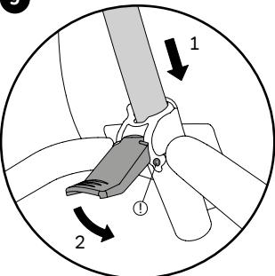
Вставить толкатель в держатель для седла и зафиксировать. При этом следить за тем, чтобы фиксатор (пружина) правильно зафиксировался (!).
