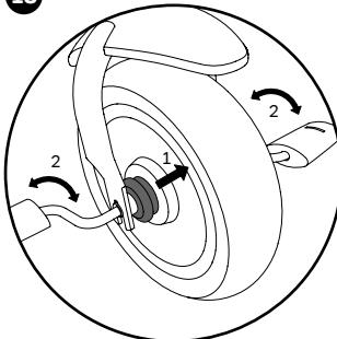
Disattivare la ruota libera affinché il bambino possa pedalare da solo: per farlo, spostare l'anello di blocco contro il cerchio fino ad innestarla in posizione. Ruotare leggermente la pedivella per facilitare l'innesto in posizione.
