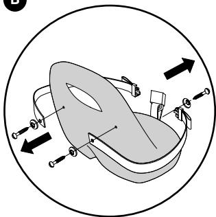
Verwijderen de gordel door de schroeven los te draaien.
