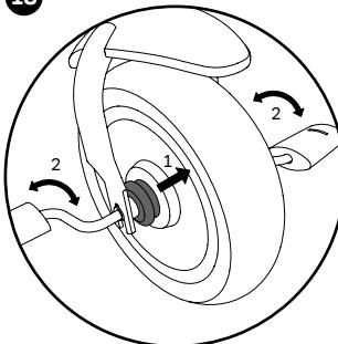
Den Freilauf deaktivieren, damit das Kind selber treten kann: dazu den Arretier-Ring gegen die Felge schieben, bis dieser einrastet. Kurbel leicht drehen, erleichtert das Einrasten.
