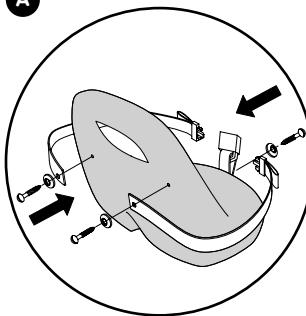
A Upevněte děrované konce pásu pomocí přiložených šroubů do určeného prohloubení na sedle tříkolky. Pozor! Šrouby utáhněte pouze ručně, protože nadměrným dotáhnutím dojde k poškození plastových dilů.
