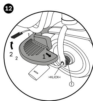
Inserte el reposapiés en la manivela y fije el cinturón en el cuadro. Si se usa el reposapiés tiene que estar puesta la marcha libre - Retirar la anilla de encastrado de la llanta (!).
