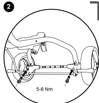
Schrauben einsetzen und festschrauben.
