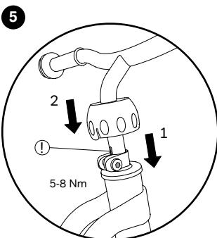
Insérer le guidon sur la fourche jusqu'à la butée et serrer la vis. Ensuite, pousser la calotte sphérique vers le bas jusqu'à ce qu'elle s'enclenche. Alignez la fente de la barre du guidon vers l'arrière (!).
