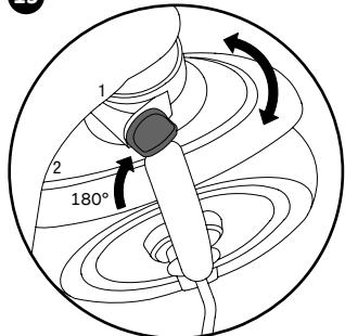
Ruotare la manopola di 180° per attivare o disattivare il blocco del manubrio.
