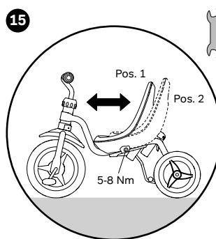
La posición del asiento se puede modificar sin fases aflojando ligeramente la unión atornillada. Despues, vuelva a apretar bien la unión atornillada.
