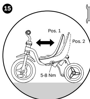
De positie van het zijtje kan traploos worden versteld door de Schroefverbinding iets los te draaien. Daarna draait u de Schroefverbinding weer goed vast.
