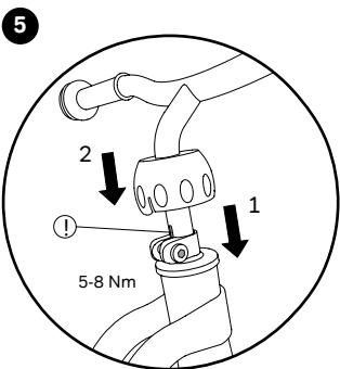
Řídítka nasuňte na sloupek vidlice až na doraz a dotáhněte šroub. Kulatý kryt poté zatlačte pevně dolů, dokud nezapadne. Drážku v řídítce nasměrujte dozadu(!).
