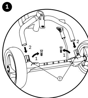
Dévisser les vis et insérer l'essieu arrière dans le cadre. Aligner les écrous carrés vers l'arrière (!).
