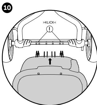
Mulde auf die Hinterachse aufstecken, bis sie einrastet.
