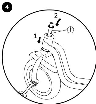
Gabelschaft durch das Steuerkopfrohr, bis zum Anschlag aufsetzen. Unterlegscheibe wieder aufsetzen. Nasen am Gabelschaft nach hinten ausrichten (!).
