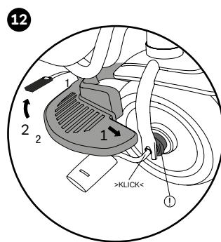
Die Fußstütze auf die Kurbel aufstecken und den Gurt am Rahmen befestigen. Bei Verwendung der Fußstütze muss der Freilauf eingeschaltet sein - Arretier-Ring von der Felge weg ziehen (!).
