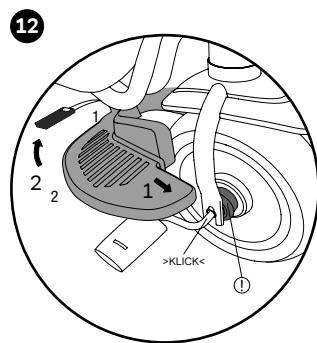
Placer le repose-pied sur la manivelle et fixer la sangle au cadre. En cas d'utilisation d'un repose-pied, le roulement libre doit être activé - La bague de blocage doit s'éloigner de la roue (!).
