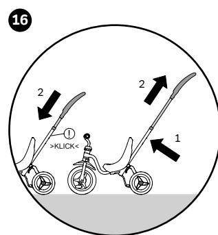
Ajuste la altura de la barra de empuje, presionando el encastrado (resorte). Asegúrese de que el encastrado (resorte) enganche correctamente.
