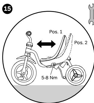
Pozycję siedzenia można regulować bezstopniowo przez lekkie poluzowanie połączenia skręcanego. Następnie ponownie dokręcić połączenie skręcone.
