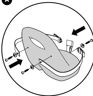
Vergrendel de geperforeerde uiteinden van de gordel met de meegeleverde schroeven in de bijbehorende uitsparingen op het zitje van de driewieler. Let op! Draai de schroeven handvast aan, want te vast aandraaien kan de kunststof onderdelen beschadigen.
