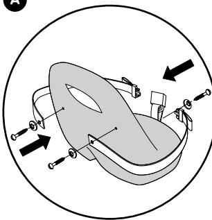
Arretieren Sie die gelochten Enden des Gurtes mittels beigelegter Schrauben in vorgesehene Körnung am Dreiradsitz. Achtung! Schrauben nur handfest anziehen, da zu festes Anziehen zur Schädigung der Kunststoffteile führt.
