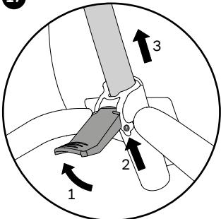
Afmontering af skubbestangen: Løsn sikkerhedshåndtaget, tryk på låsen (fjeder) og træk stangen ud.
