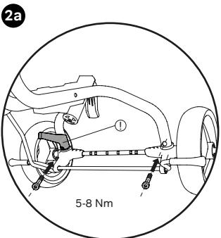
Nur bei Modell Ceety Comfort: Schraube links zusätzlich durch die Öffnung der Festelbremse (!) führen und festschrauben.
