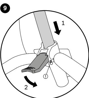
Posuvnou tyč zastrčte do držáku sedla a zajistěte. Dbejte na to, aby aretace (pružení) správně zapadlo(!).
