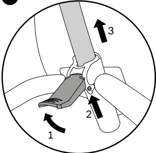
Retirer la barre coulissante : Desserrer le levier de sécurité, appuyer sur le blocage (ressort) et faire sortir la barre.
