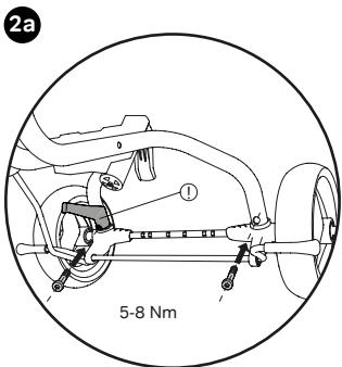
Solo per il modello Ceety Comfort: far passare la vite a sinistra anche attraverso l'apertura del freno di stazionamento (!) e serrare.
