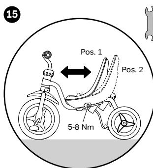
Die Sitzposition kann stufenlos verstellt werden, indem die Verschraubung etwas gelöst wird. Verschraubung danach wieder ausreichend festdrehen.
