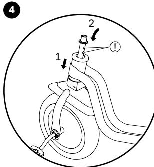
Placer la fourche dans le tube de direction jusqu'à la butée. Replacer la rondelle. Alignez les ergots de la fourche vers l'arrière (!).
