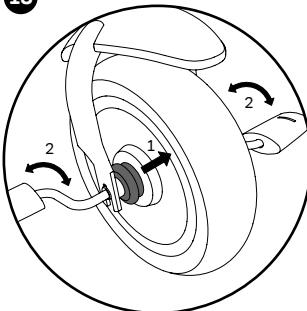
Desactivar la marcha libre, para que el niño pueda pedalear: para ello empujar la anilla de encastreado hacia la llanta hasta que enganche. Girando ligeramente la manivela se facilita el encastreado.
