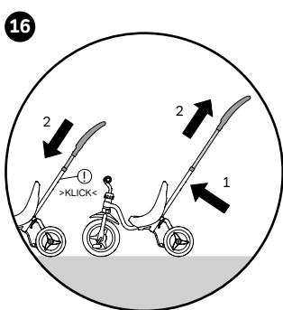
Wyregulować wysokość pręta popychacza przez naciśnięcie rygla (sprężyna). Upewnić się, że rygiel (sprężyna) ponownie prawidłowo się zatrzasnął.
