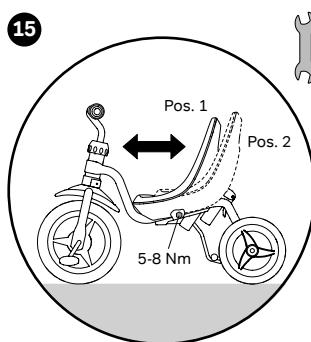
La position d'assise peut être réglée en continu en desserrant légèrement le raccord visqué. Ensuite, resserrer suffisamment le raccord visqué.
