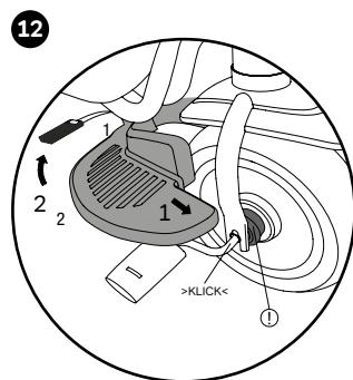
Насадить подножку на кривошип и закрепить ремень на раме. При использовании подножки должен быть включен холостой ход — снять стопорное кольцо с обода (!).
