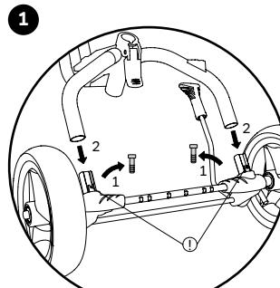
Schrauben herausdrehen und Hinterachse in Rahmen einstecken.
