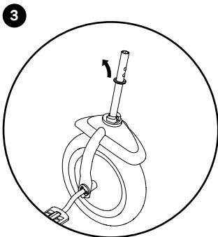
Transportsicherung (Pappe, Gummiband) entfernen und die Unterlegscheibe abnehmen.
