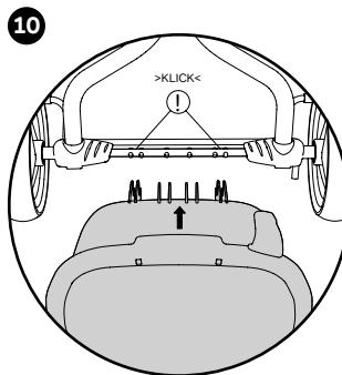
Placer la benne sur l'essieu arrière jusqu'à ce qu'elle s'enclenche.
