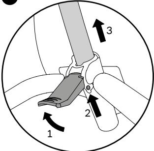
Schiebestange entnehmen: Sicherheitshebel lösen, Arretierung (Feder) drücken und die Stange herausziehen.
