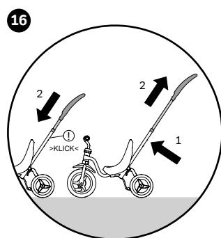
Régler la hauteur de la barre coulissante en appuyant sur le blocage (ressort). Veiller à ce que le blocage (ressort) s'enclenche correctement.
