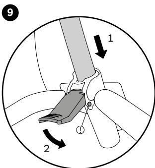
Schiebestange in den Sitzhalter stecken und verriegeln. Achten sie darauf, dass die Arretierung (Feder) korrekt einrastet (!).
