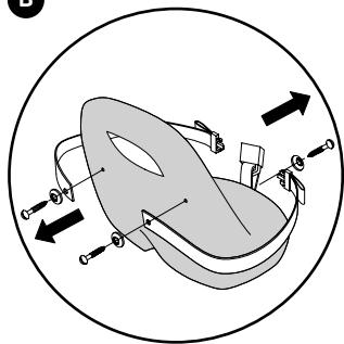
Entfernen Sie den Gurt mittels Lösen Schrauben.
