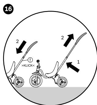
Indstil skubbestangens højde, ved at trykke på låsen (fjeder). Sørg for, at låsen (fjeder) klikker korrekt fast igen (!).
