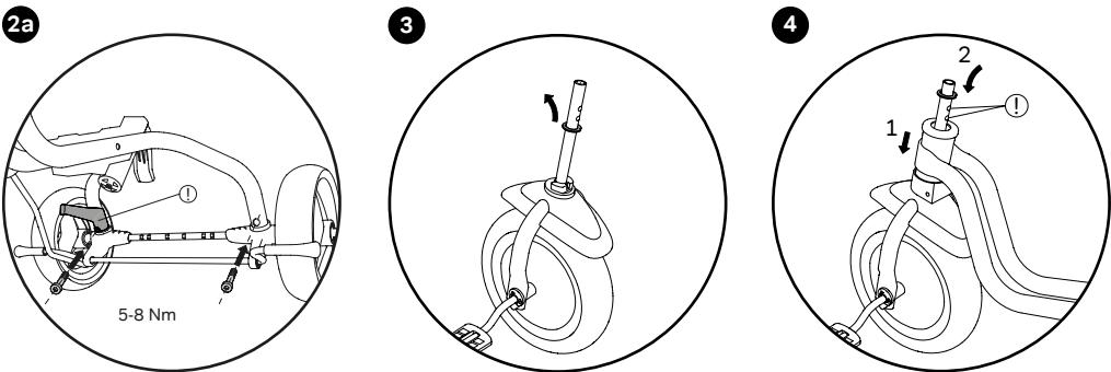
Alleen bij model Ceety Comfort: schroef links extra door de opening van de parkeerrem (!) leiden en vastschroeven.
