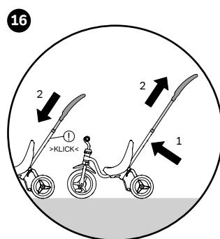
Schiebestange in der Höhe einstellen, indem die Arretierung (Feder) gedrückt wird. Achten Sie darauf, dass die Arretierung (Feder) wieder korrekt einrastet.
