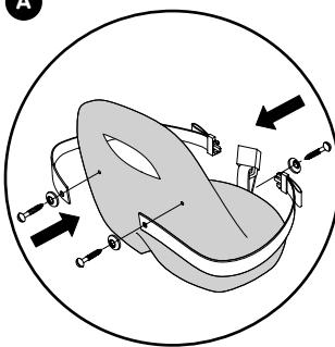
Bloccare le estremità perforate della cinghia con le viti accluse nell'apposita granulazione sul sedile del triciclo. Attenzione! Serrare le viti a mano, in quanto un serraggio troppo forte potrebbe danneggiare le parti di plastica.
