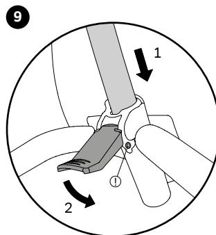
Stik skubbestangen i sædeholderen og lås den. Sørg for, at låsen (fjeder) klikker korrekt fast (!).
