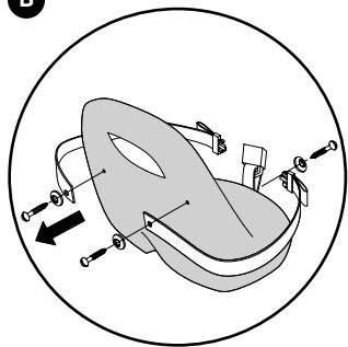
Bloquez les extrémités perforées de la sangle dans la granulométrie prévue de la selle du tricycle à l'aide des vis fournies. Attention ! Ne serrer les vis qu'à la main, car un serrage excessif endommage les pièces en plastique.
