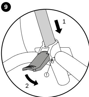
Inserire il manico di spinta nel portasellino e bloccarlo. Accertarsi che il blocco (molla) si innesti correttamente in posizione (!).
