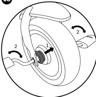
Wyłączyć wolne koło, aby dziecko mogło pedałować, dociskając do zatrzaśnięcia pierścień blokujący do obręczy. Obróć lekko korbę, aby ułatwić załączenie.
