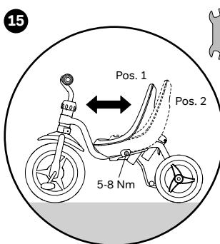
La posizione di seduta può essere regolata in modalità continua allentando leggermente il collegamento a vite. Il collegamento a vite può essere poi serrato nuovamente.
