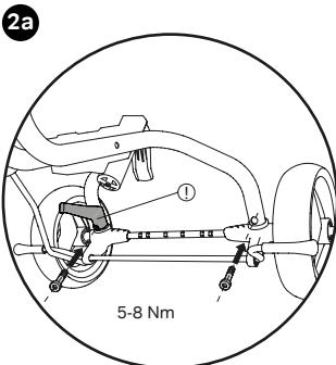
Uniquement pour le modèle Ceety Comfort : insérer la vis de gauche dans l'orifice du frein (!) et la visser.
