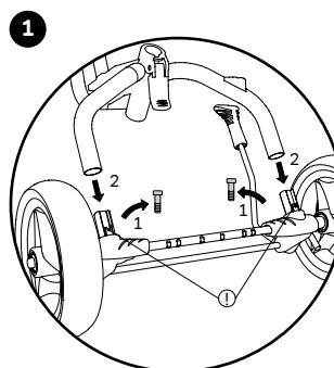
Выкрутить винты и вставить заднюю ось в раму. Квадратная гайка должна быть ориентирована назад (!).
