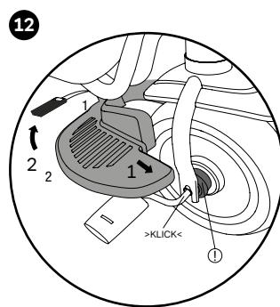
Inserire il poggiapiedi sulla manovella e fissare la cintura al telaio. Nell'utilizzare il poggiapiedi, attivare la ruota libera: rimuovere l'anello di blocco dal cerchio (!).
