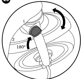
Obrócić przełącznik o 180°, żeby wyłączyć lub wyłączyć blokadę kierownicy.
