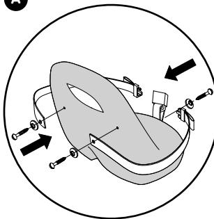
А Зафиксируйте перфорированные концы ремня с помощью прилагаемых винтов в предусмотренном отверстии на седле трехколесного велосипеда. Внимание! Затягивать винты только вручную, слишком тугая затяжка может привести к повреждению пластиковых деталей.
