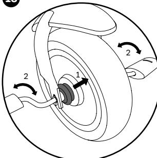
De vrijloop deactiveren zodat het kind zelf kan trappen: schuif daarvoor de borgring tegen de velg totdat deze vastklikt. Crankarm iets draaien, dit vergemakkelijkt het vastklikken.
