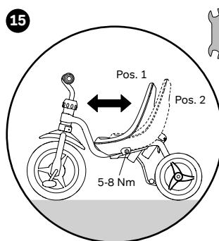
Можно плавно менять положение седла, слегка ослабив резьбовое соединение. После этого снова затянуть резьбовое соединение.
