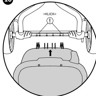
Надеть лоток на заднюю ось таким образом, чтобы он зафиксировался.
