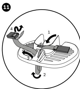
Den beigefügten Gurt zuerst durch die Fußstütze, dann durch den Gurt-Riegel ziehen.
