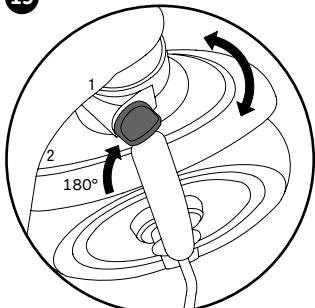
Draaiknop 180° draaien om de stuurvergrendeling in of uit te schakelen.
