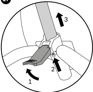
Wymianowanie pręta popychacza: Poluzować dźwignię bezpieczeństwa, wciśnąć rygiel (sprężynę) i wyciągnąć pręt.
