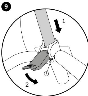
Insérer la barre coulissante dans le support de selle et la verrouiller. Veillez à ce que le blocage (ressort) s'enclenche correctement (!).
