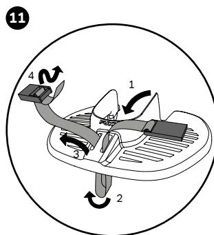
Пропустить прилагаемый ремень сначала через подножку, затем через фиксатор ремня.
