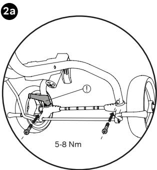
Pouze u modelu Ceety Comfort: Dodatečně zavedte šroub vlevo otvorem parkovací brzdy (!) a pevně ho přitáhněte.
