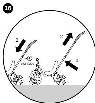
Výšku posuvné tyče nastavte stisknutím aretace (pružení). Dbejte na to, aby aretace (pružení) zase správně zapadla.
