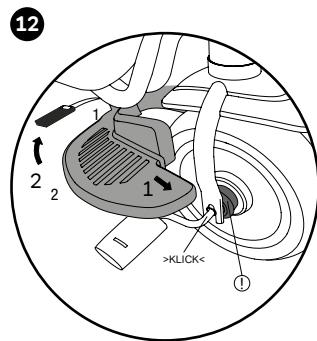
De voetsteun op de crankarm steken en de riem aan het frame bevestigen. Bij gebruik van de voetsteun moet de vrijloop ingeschakeld zijn – trek de borging van de veug weg (!).
