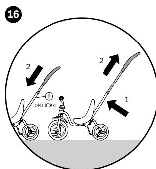
Regolare il manico di spinta in altezza schiacciando il blocco (molla). Accertarsi che il blocco (molla) s'inneschi di nuovo correttamente in posizione.
