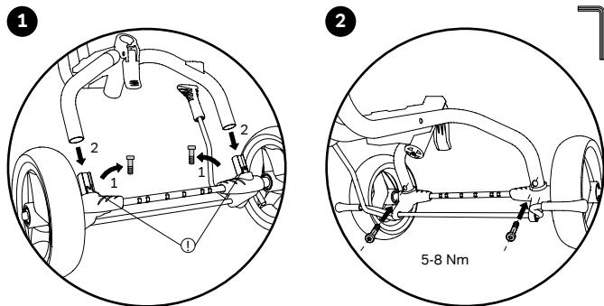
Svitare le viti e inserire l'asse posteriore nel telaio.
