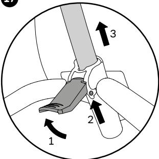
Retirar la barra de empuje: Suelte la palanca de seguridad, presione el encastreado (resorte) y extraiga la barra.
