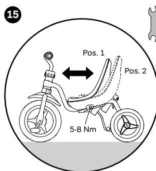
Siddepositionen kan indstilles trinløst, ved at løse forskruningen lidt. Spænd derefter forskruningen tilstrækkeligt igen.
