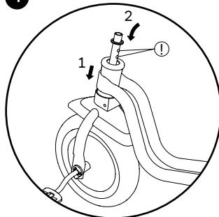
Только для модели Ceety Comfort: винт слева дополнительно пропустить через отверстие в стояночном тормозе (!) и закрутить.
