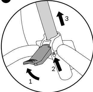
Снять толкатель: ослабить предохранительный рычаг, нажать на фиксатор (пружину), и вытянуть штангу.
